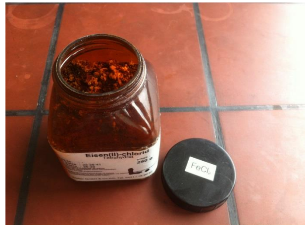
Bild 3: Braun! Als Eisen(II)-chlorid nicht mehr verwendbar!
